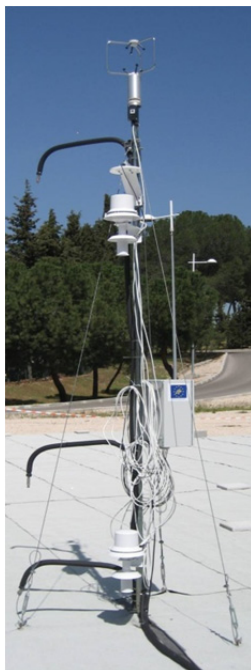
Figura 2. Detalles de plataforma experimental: a) mástil con sensores y sondas; b) caseta de control; c) sistema de control, adquisición y tratamiento de datos.
