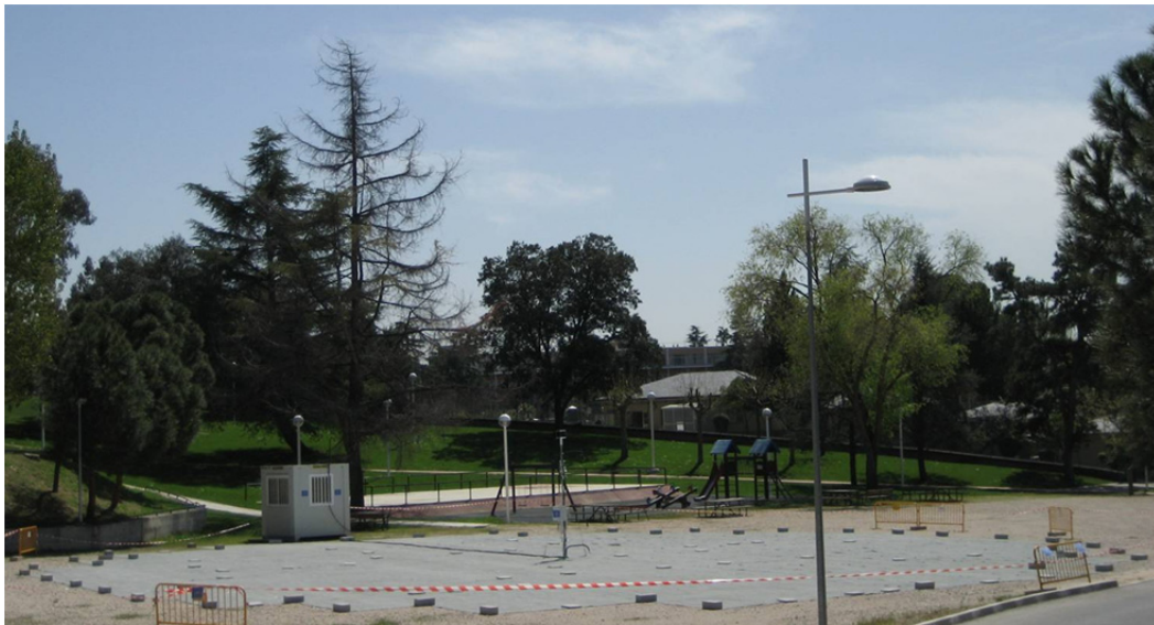
Figura 1. Plataforma experimental para la para la medida de la velocidad de depósito de \text{NO}_x sobre superficies fotocatalíticas en ambiente exterior (instalaciones del CIEMAT).
